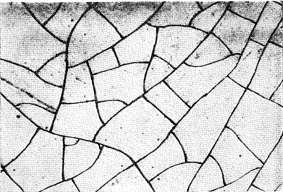
Rys. 20. Układ spękań szkliva, podłużnych i poprzecznych, wskazujący dążenie do zachowania kątów prostych między rysami wcześniejszymi i późniejszymi.
