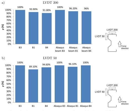
FIG. 6. Displacement reduction parameter  $\rho_i$ : a) vertical displacement LVDT 200, b) horizontal displacement LVDT 50.
