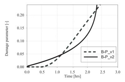
Fig. 6. Damage parameter evolution for B1900+Hf at 982° C,  $\sigma=283~\mathrm{[MPa]}=\mathrm{const.}$
